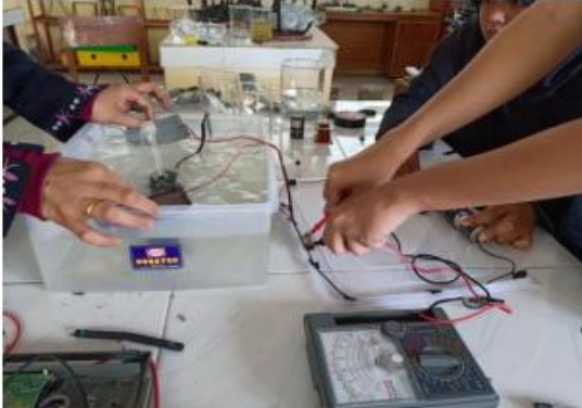
Gambar 2. Pengukuran potensi arus listrik air kolong yang tidak dicampur dengan sedimen kolong
