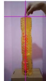
**Gambar 3.** Lintasan gerak kelereng hasil analisis aplikasi tracker
