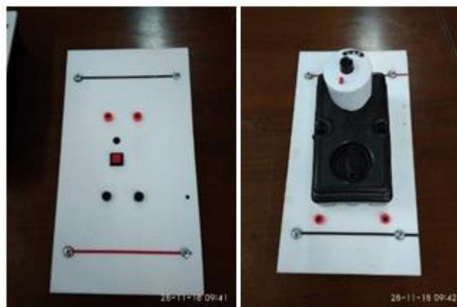
Gambar 7. Panel Sikring Otomatis dan Sikring Elektronik
