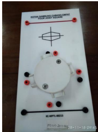
Gambar 40. Panel Kotak Sambung Cabang Empat
