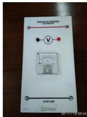
Gambar 10. Panel Volt Meter (AC)
