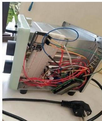
**Gambar 9.** Sistem kendali mikrokontroler pada oven
