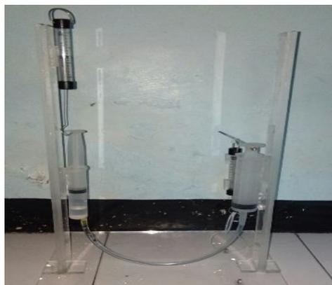
**Gambar 5. Pompa Pascal Sederhana Hasil Perbaikan**
