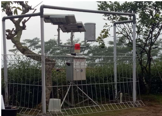
Gambar 4. Implementasi sistem peringatan dini tanah longsor
