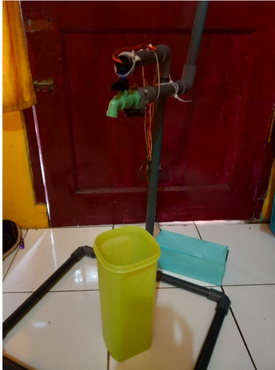
Gambar 5. Rancangan Pengisian Toren Air Otomatis
