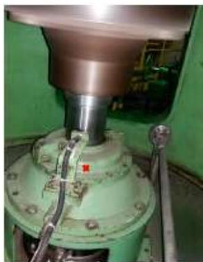
Gambar 2. Titik Pengukuran Vibrasi
