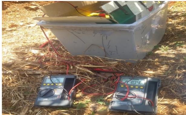
**Gambar 6.** Pendeteksian Arus Listrik dan Beda Potensial yang Terukur
